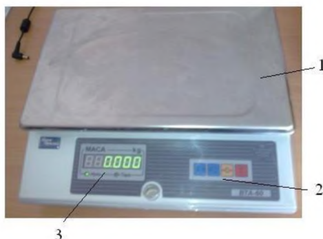
Рисунок 3.5 – Електронні лабораторні і ваги: 1 –деко; 2 – панель калібрування; 3 –дисплей
