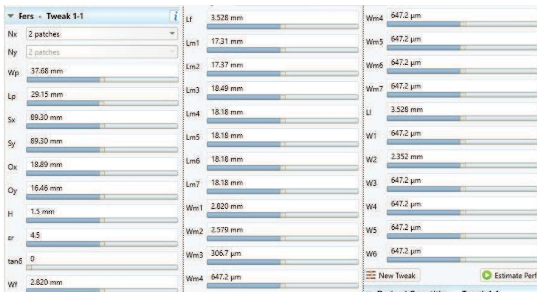
Рисунок 3.22 – Розміри антени «M-by-N rectangular patch array with corporate feed» після зміни розмірів патчів
