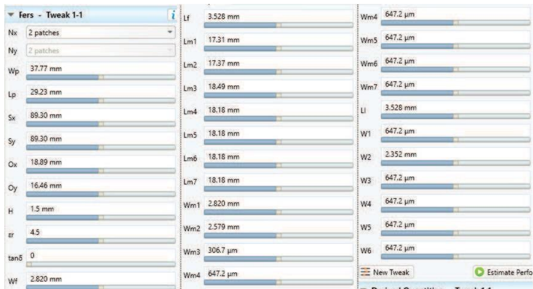
Рисунок 3.17 – Розміри антени «M-by-N rectangular patch array with corporate feed»
