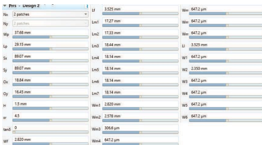
Рисунок 3.24 – Розміри антени «M-by-N rectangular patch array with corporate feed» після зміни розмірів ліній узгодження
