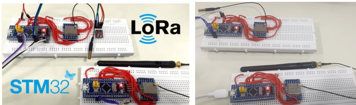
Рисунок 3.2. – Зовнішній вигляд системи на базі STM32 та LoRa
