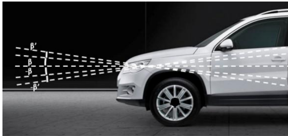
Рисунок 1.7 – Вертикальний діапазон регулювання фар у системі AFS [6]
