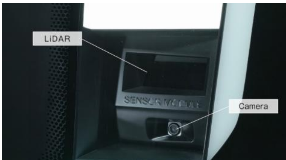
Рисунок 1.5 – Адаптивна система освітлення з використанням сенсорного модуля розширеного аналізу обстановки [5]
