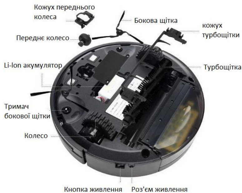
Рисунок 1. - Основні компоненти конструкції робота-пилосмока
