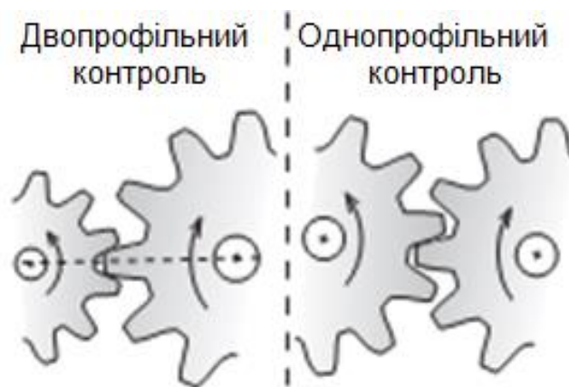
Рис.1. Схеми одно- та двопрофільного контролю зубчатих коліс
