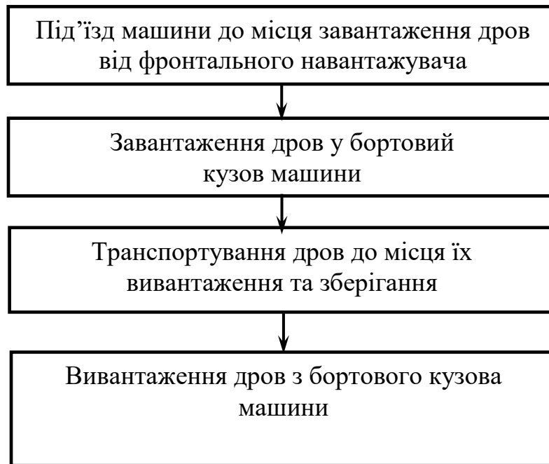
Рисунок 2.1 – Структурна схема роботи машини для переміщення дров населенню
