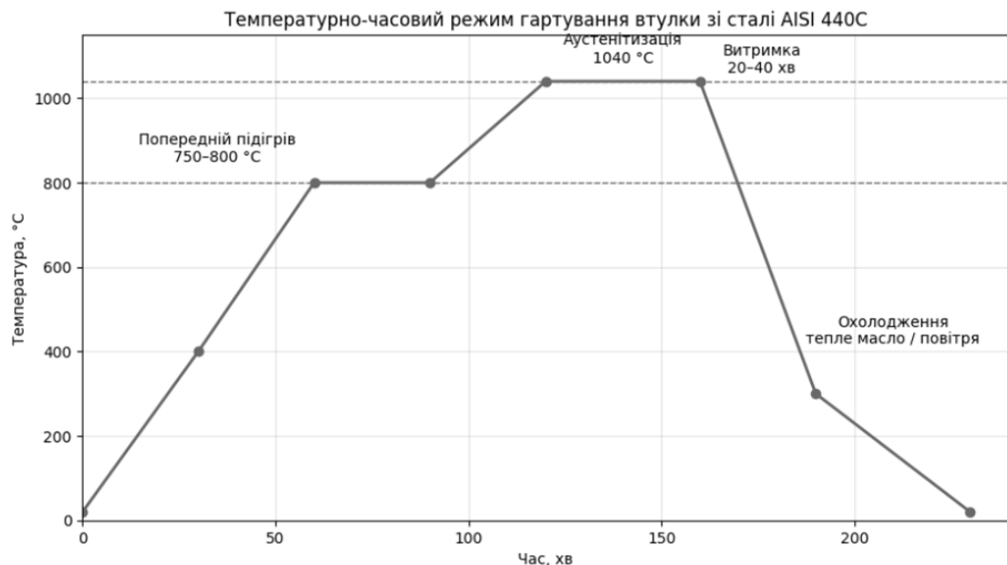
Рисунок 3.1 – Температурно-часовий режим гартування втулки вала відцентрового насоса зі сталі AISI 440C
