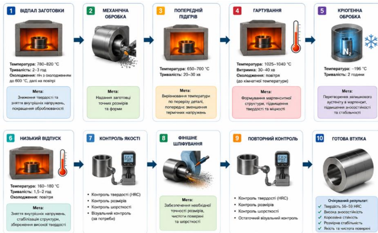
Рисунок 3.6 – Технологічний процес термічної обробки втулки зі сталі AISI 440C
