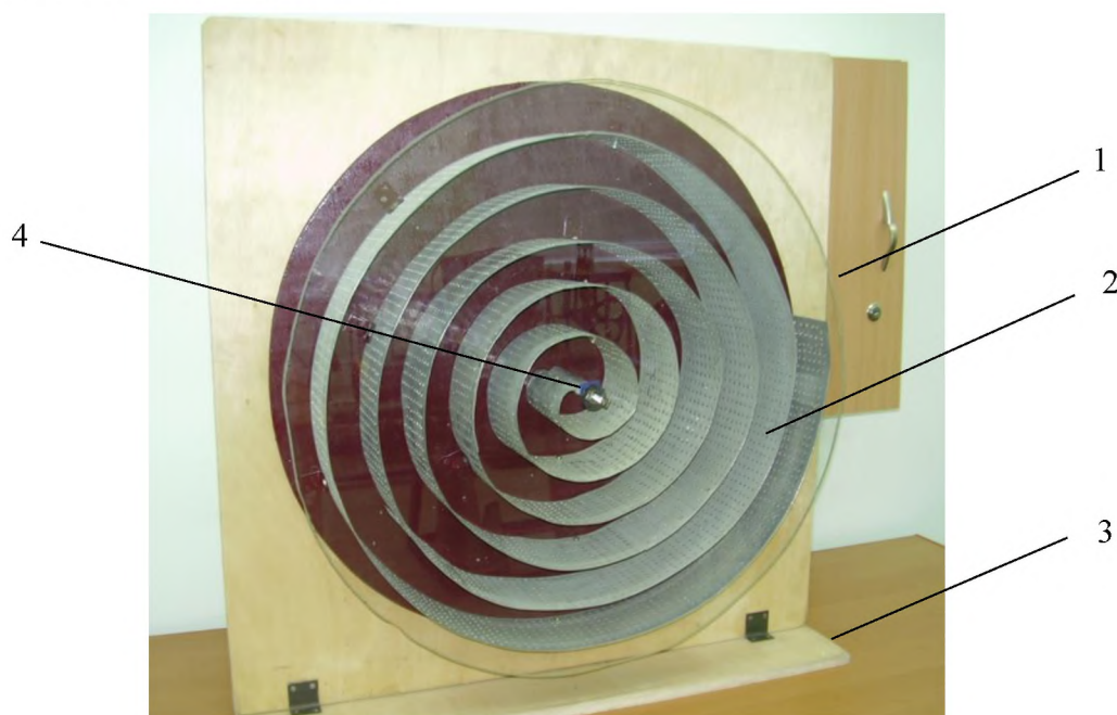
Рисунок 3.1 – Лабораторна установка для дослідження параметрів спіралеподібної перфорованої поверхні: 1 – оргскло; 2 – спіралеподібна перфорована поверхня; 3 – станина; 4 – привод обертання спіралеподібної перфорованої поверхні
