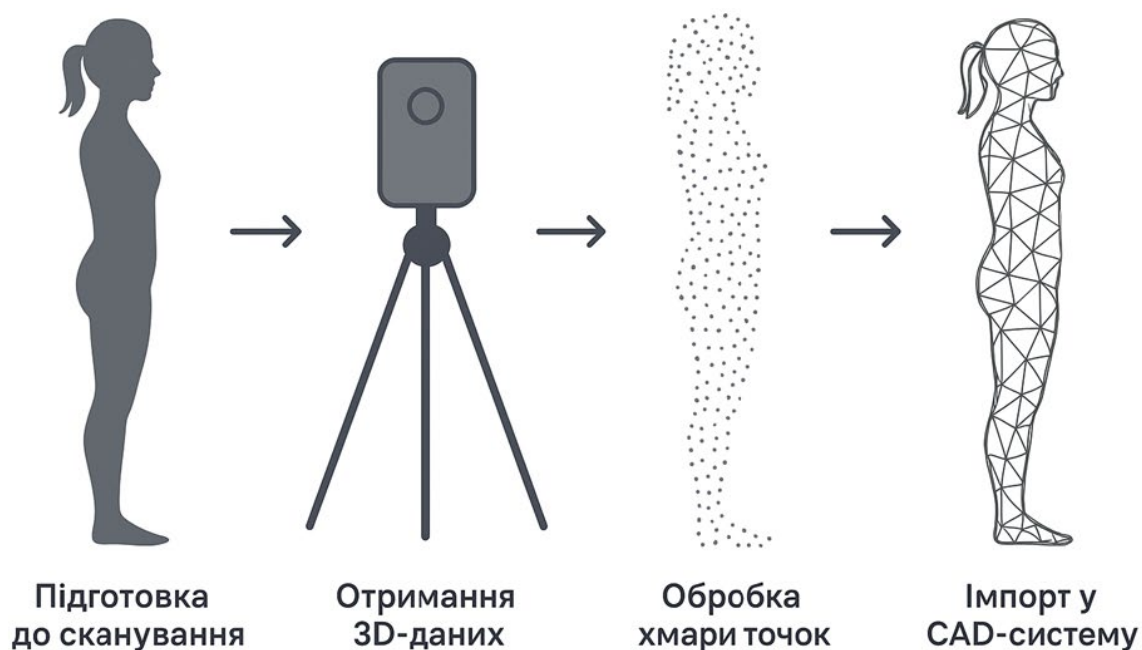
Рисунок 4.1 Схема процесу 3D сканування тіла людини
