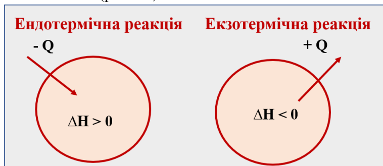
Рис.18. Зв'язок між ентальпією та теплотою хімічної реакції.
