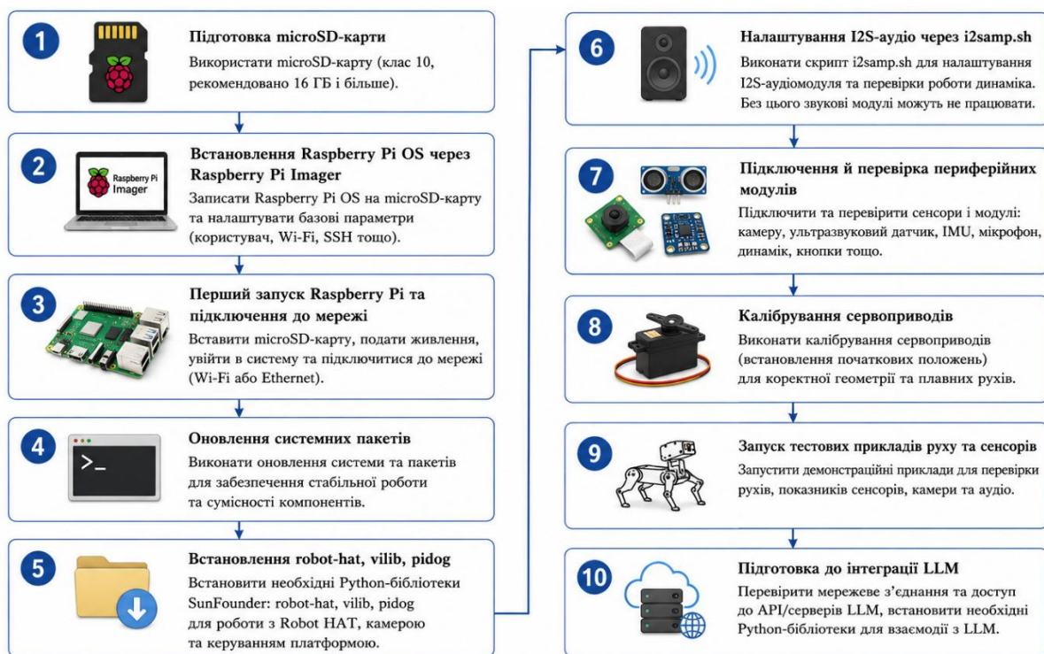
Рисунок 3.4 – Послідовність налаштування Raspberry Pi та програмного середовища для SunFounder PiDog
