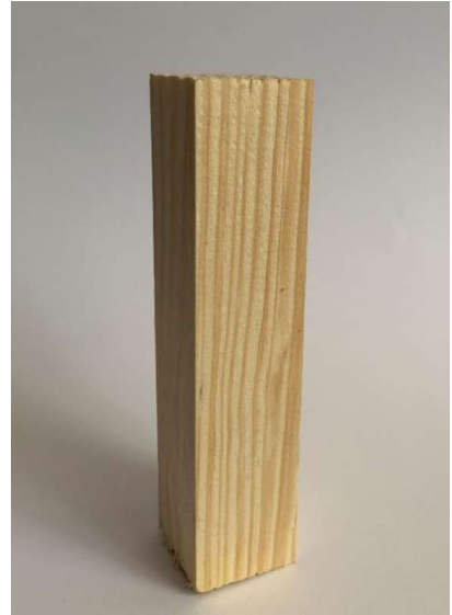
Рис. 2.2. Дослідні зразки деревини за стандартної вологості 12%: а) берези; б) сосни
