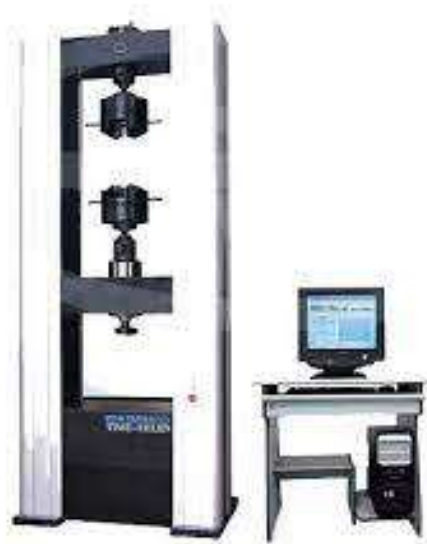
Рис. 1.6. Універсальна випробувальна розривна машина WDW-300E
