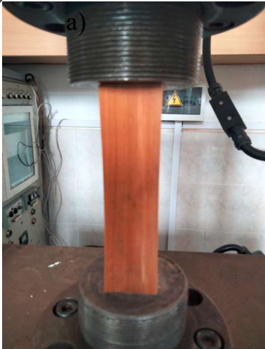
Рис. 2.8. Дослідні зразки деревини просочені соляною кислотою (15%), які знаходяться в робочому положенні перед початком випробувань з терміном просочення 7 днів: а) берези; б) сосни
