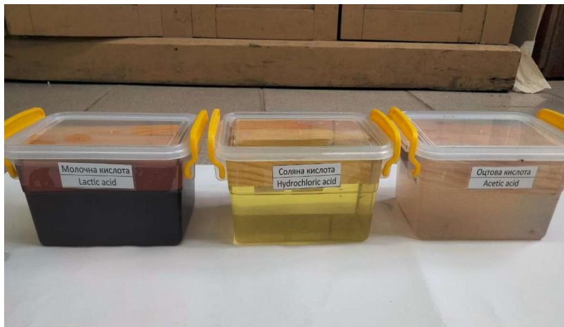
Рис. 2.3. Просочення дослідних зразків деревини у молочній (40%), соляній (15%) та оцтовій (9%) кислотах
