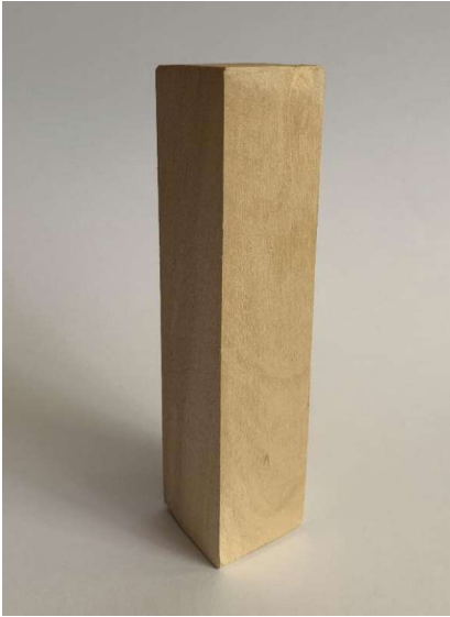
Рис. 2.2. Дослідні зразки деревини за стандартної вологості 12%: а) берези; б) сосни
