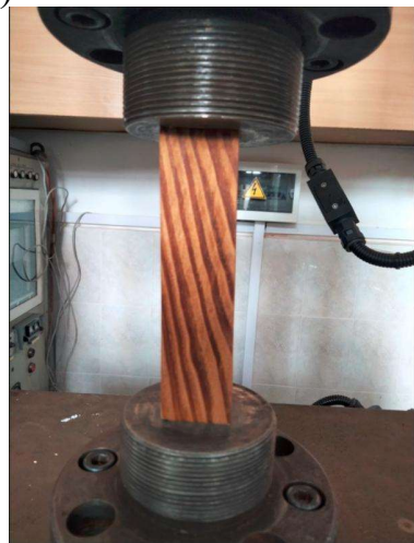
Рис. 2.8. Дослідні зразки деревини просочені соляною кислотою (15%), які знаходяться в робочому положенні перед початком випробувань з терміном просочення 7 днів: а) берези; б) сосни
