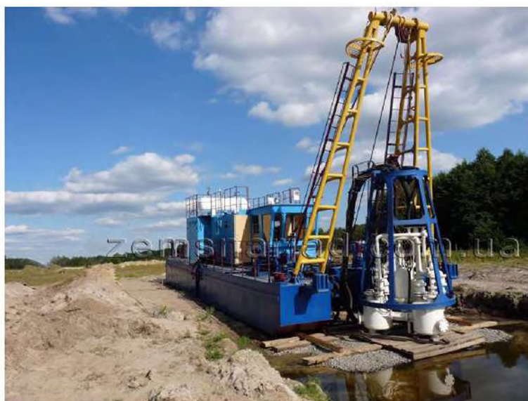
Рисунок 1.5. – Вакуумна установка для сапропелю на базі земснаряду МЗ-20Е.
