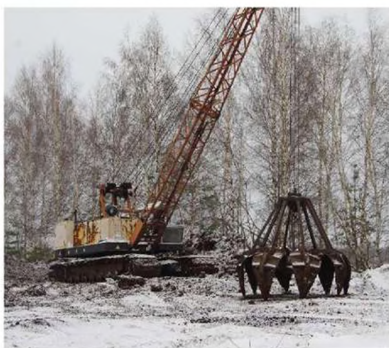
Рисунок 1.1. грейферні установки в роботі з торфом та сапропелем
