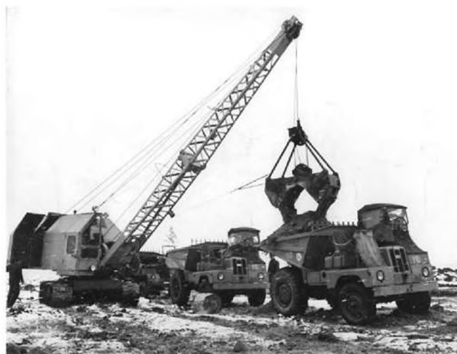
Рисунок 1.1. грейферні установки в роботі з торфом та сапропелем
