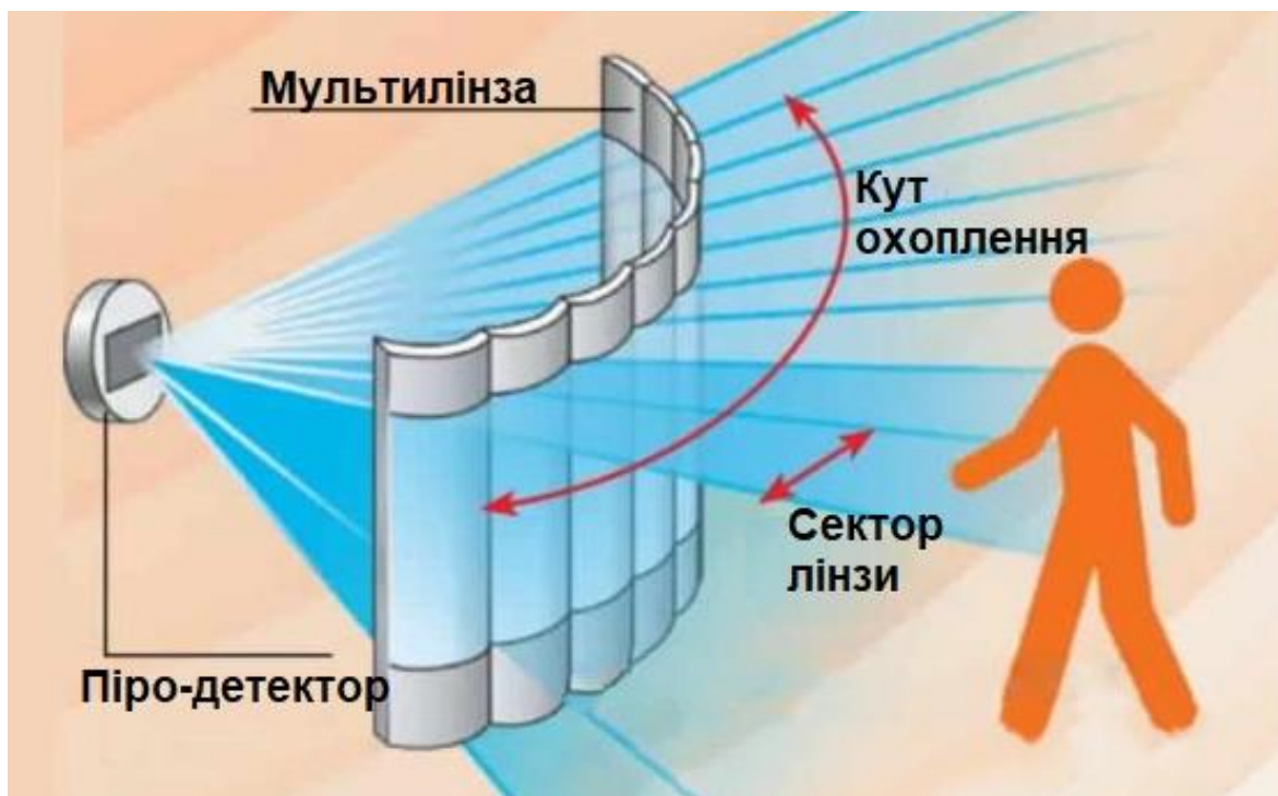
Рисунок 1.2 – Принцип роботи інфрачервоних сенсорів [2]
