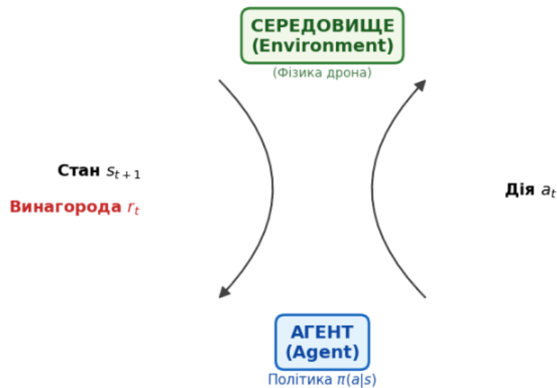
Рисунок 2.2 – Схема циклу взаємодії агента з середовищем у навчанні з підкріпленням
