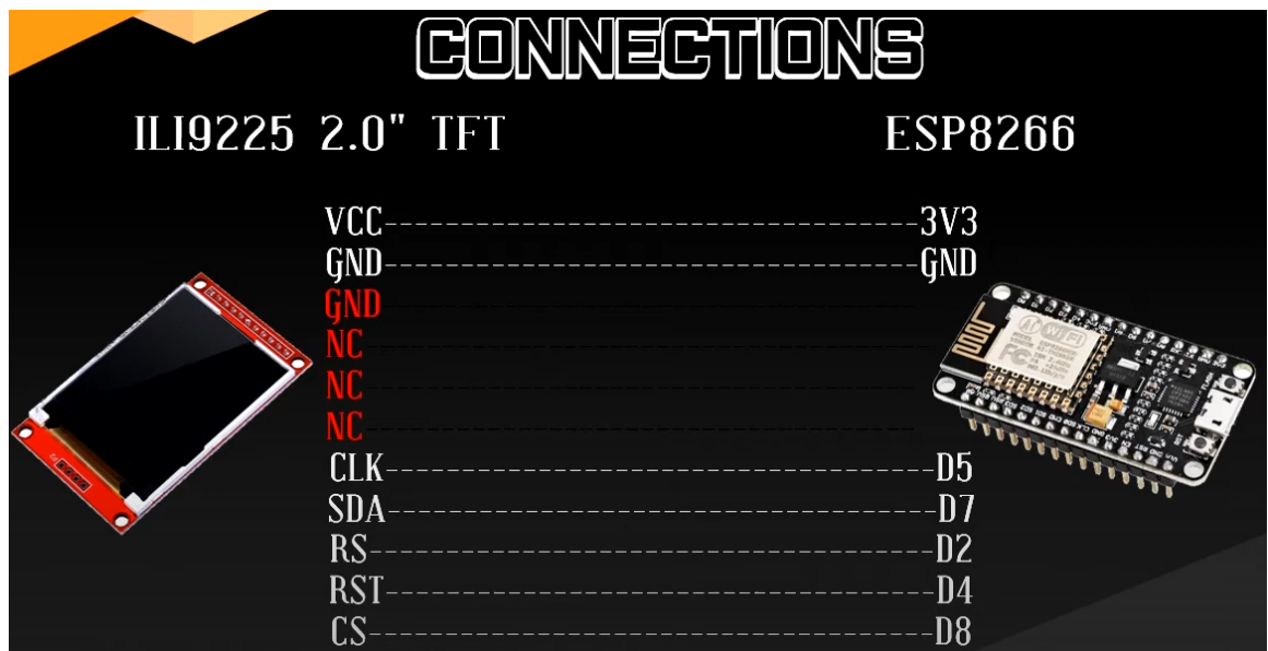
Рисунок 2.9 – З'єднання TFT дисплея до мікроконтролера [7]
