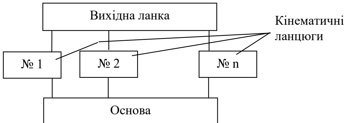
Рисунок 3.5 Узагальнена структурно-кінематична схема МПС
