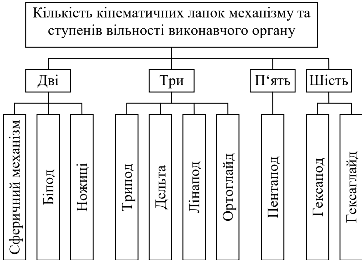
Рисунок 3.11 Класифікація технологічного обладнання з паралельною кінематикою за кількістю кінематичних ланок та ступенів вільності
