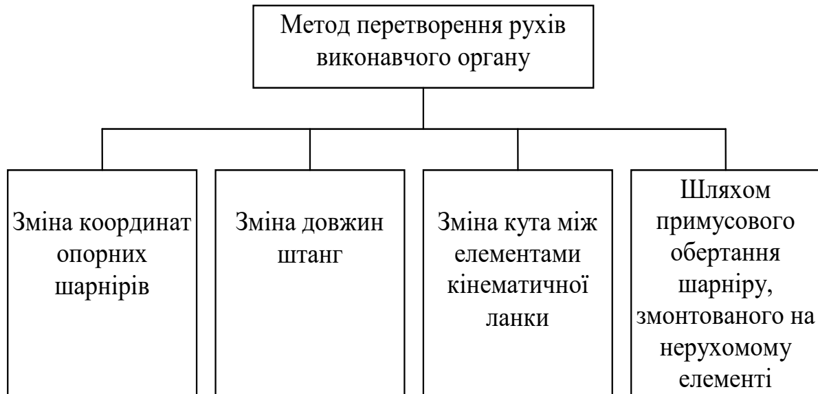
Рисунок 3.7 Класифікація механізмів паралельної структури за методом перетворення рухів виконавчого органу
