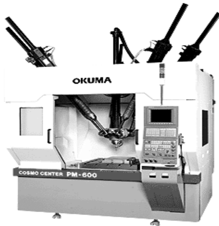
Рисунок 4.5 Загальний вигляд верстата-гексапода мод. COSMO CENTER PM-600 фірми OKUMA (Японія)
