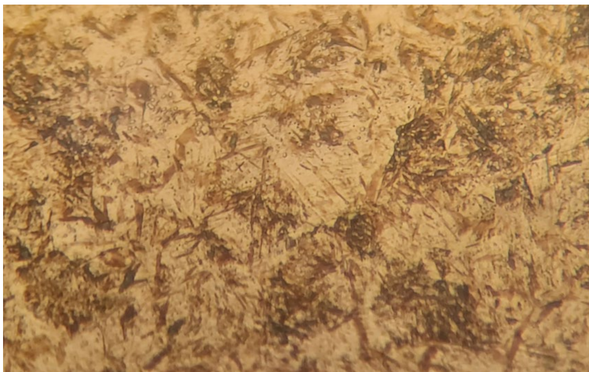
Рисунок 2.8 – Приклад структури перегріву (мартенсит MS5) x1000
