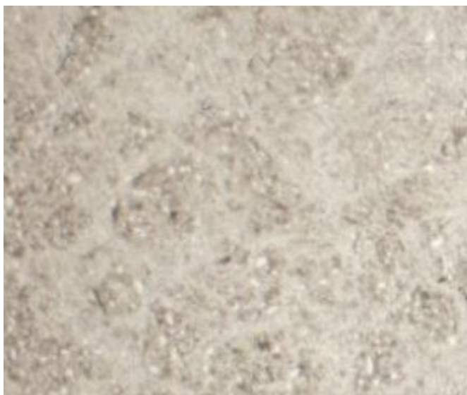
Рисунок 2.14. – Приклад троститних структур (тростит TN2) x1000
