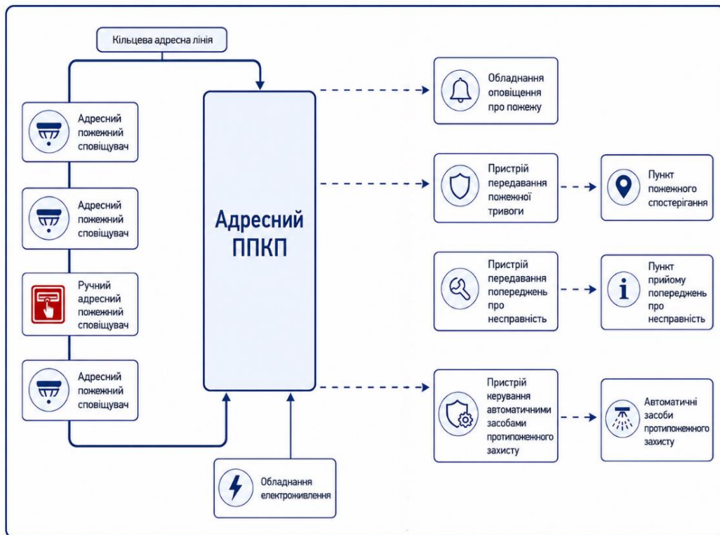
Рисунок 1.3 – Структурна схема адресної системи пожежної сигналізації (згенеровано за допомогою ChatGPT)
