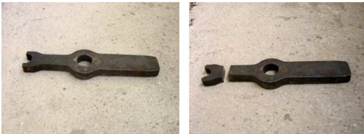
Рисунок 2.1 – Важіль розпорки колісного візка вантажного вагону. Зріз для макроаналізу (праворуч)
