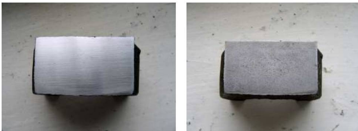
Рисунок 3.1 – Макроструктура темплету виливка, вирізаного з опорного плеча важіля: а – не травлена поверхня; б – після травлення
