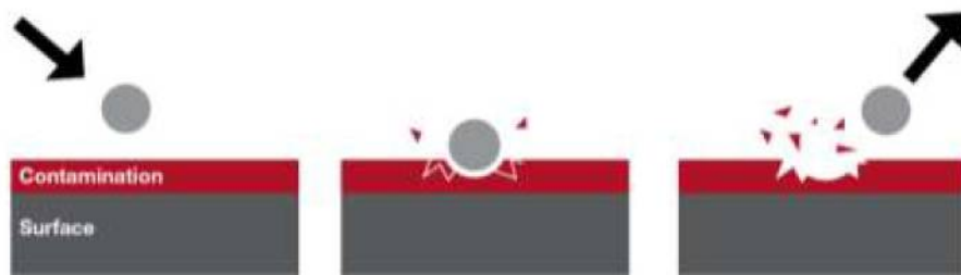
Рисунок 1.3 – Схема дії шротини на поверхню виливка [16]
