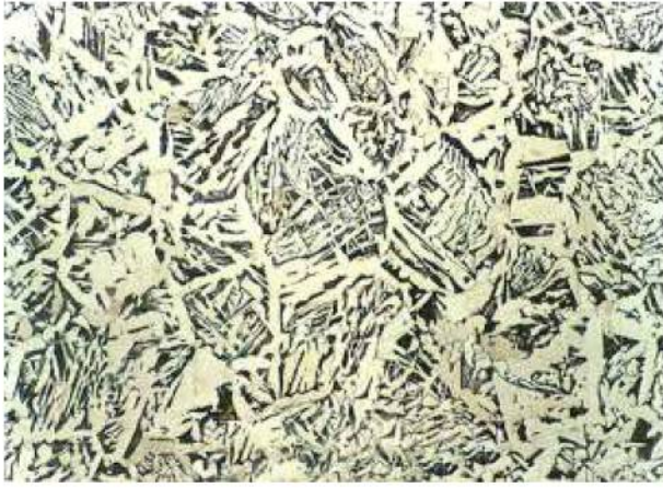
Рисунок 3.2 – Мікроструктура вилівка важіля зі сталі 20ФЛ:
