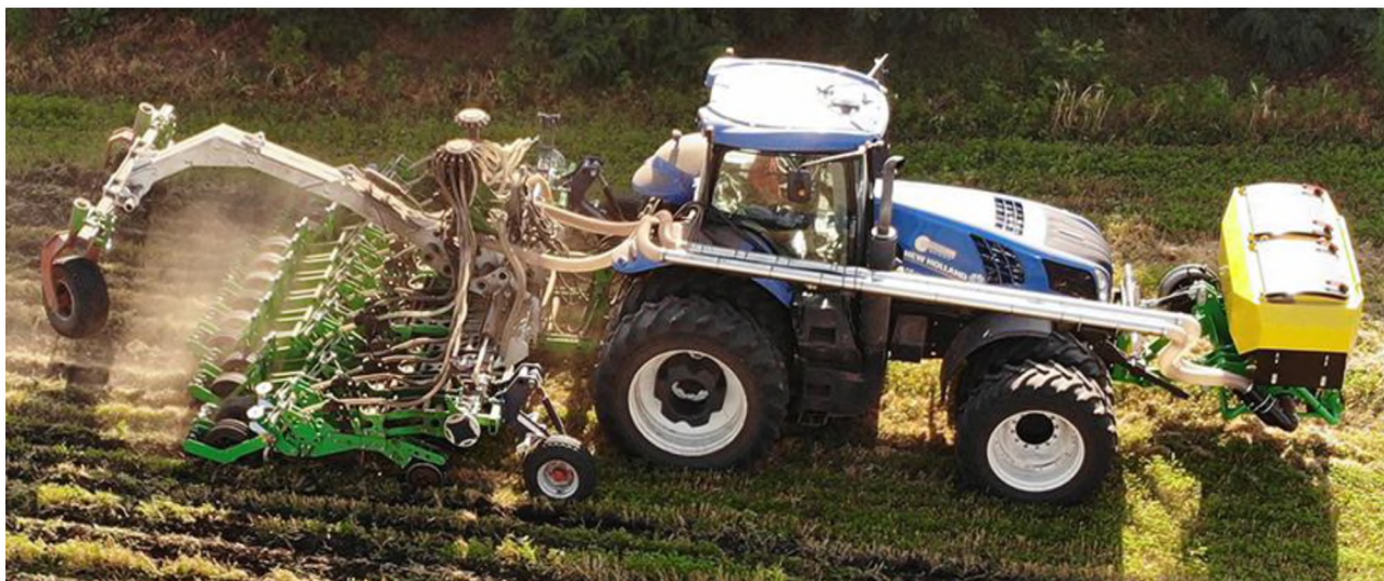
Рисунок 1.9 Фото сівалки STS Magia із двосекційним бункером навішеним на передню навіску трактора [5]
