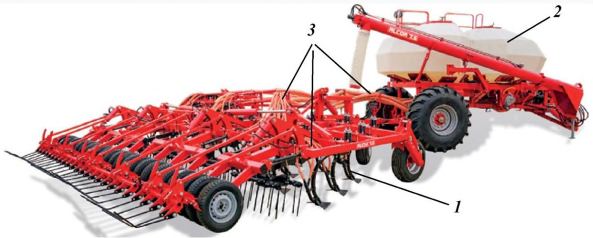
Рисунок. 1.3 Фото пневматичної сівалки ALCOR 7,5 [4]:
