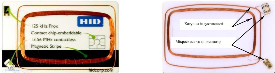
Рисунок 3.8 – Будова карти радіочастотної ідентифікації [110]
