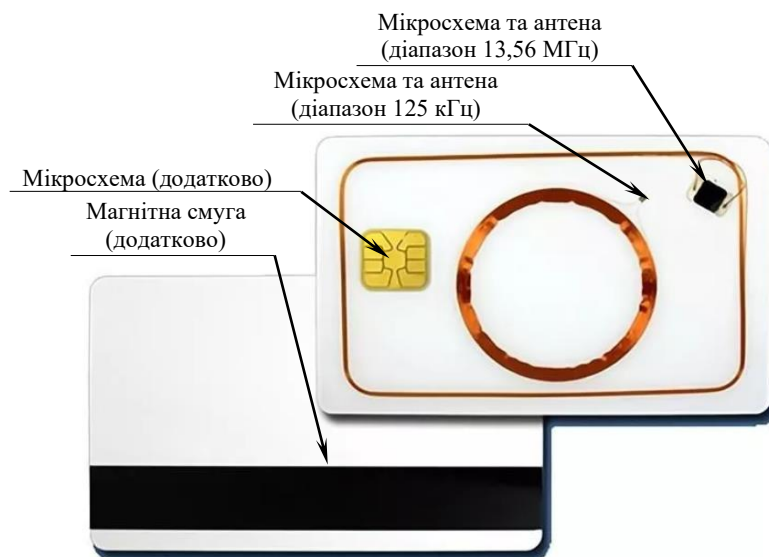
Рисунок 3.13 – Комбінована безконтактна смарт-карта [110]
