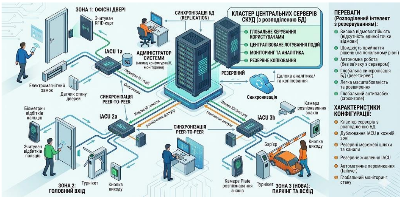
Рисунок 7.2 – Топологія розподіленого інтелекту з резервуванням
