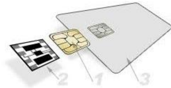
Рисунок 3.17 – Будова контактної смарт-карти [110] 1) – контактна область (6 або 8 контактів квадратної або овальної форми, позиції яких виконано за ISO 7816); 2) – контактний чіп (мікропроцесор карти); 3) – пластикова основа
