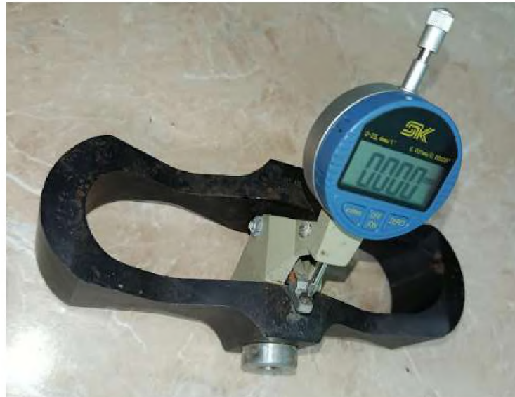
Рисунок 3.2 Скоба динамометрична обладнана індикатором вимірювання переміщення
