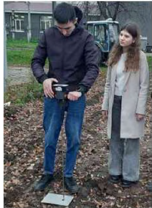
Вимірювання твердості ґрунту з допомогою твердоміра «ЛАН-М PRO»
