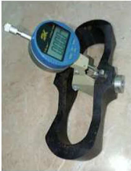
Скоба динамометрична обладнана індикатором вимірювання переміщення
