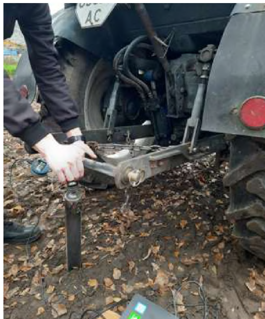
Рисунок 3.8 Процес заглиблення робочого органу у ґрунт з допомогою зусилля прикладеного від навіски трактора
