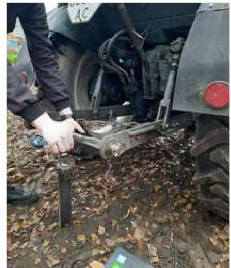
Процес заглиблення робочого органу у ґрунт з допомогою зусилля прикладеного від навіски трактора
