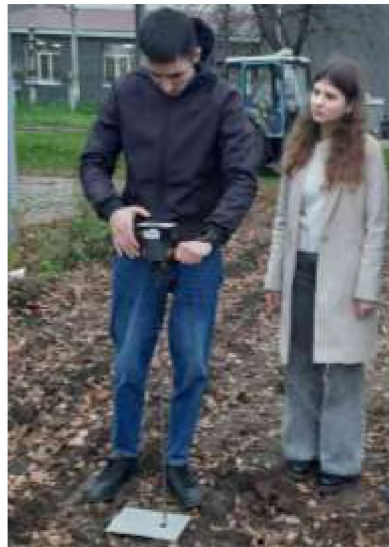
Рисунок 3.7 Вимірювання твердості ґрунту з допомогою твердоміра «ЛАН-М PRO»
