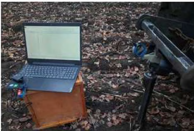
Процес заглиблення робочого органу у ґрунт з допомогою зусилля прикладеного від навіски трактора
