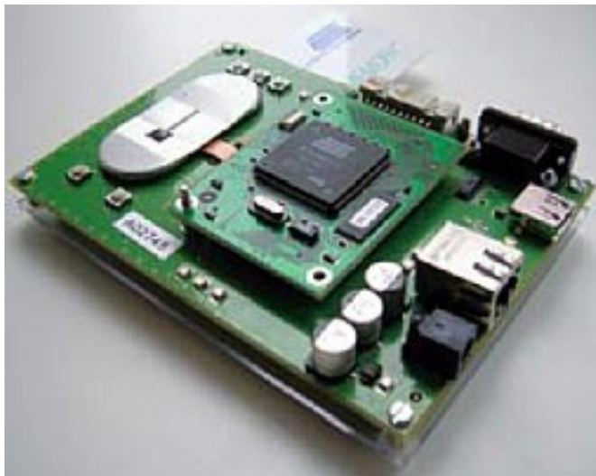
Рисунок 3.4 – Модуль біометрії AT77SM0101BCB02VEK
