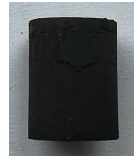
Рисунок 3.8 – Загальний вигляд біокомпозитних зразків з вмістом 140 мас. ч. лігніну із ступенем підсушування композиції:
