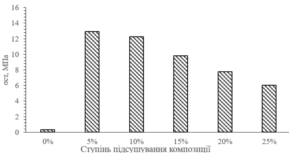
Рисунок 3.7 – Залежність міцності на стискання біокомпозитів від ступеня підсушування
