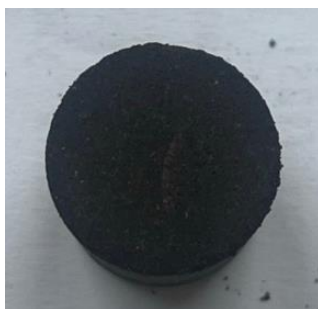
Рисунок 3.8 – Загальний вигляд біокомпозитних зразків з вмістом 140 мас. ч. лігніну із ступенем підсушування композиції:
