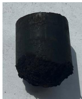
Рисунок 3.6 – Загальний вигляд біокомпозитних зразків із ступенем підсушування композиції 15% після дослідження їх міцності при стисканні, наповнених лігніном в кількості:
