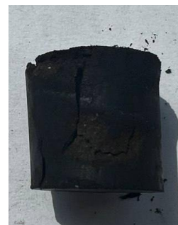
Рисунок 3.6 – Загальний вигляд біокомпозитних зразків із ступенем підсушування композиції 15% після дослідження їх міцності при стисканні, наповнених лігніном в кількості:
