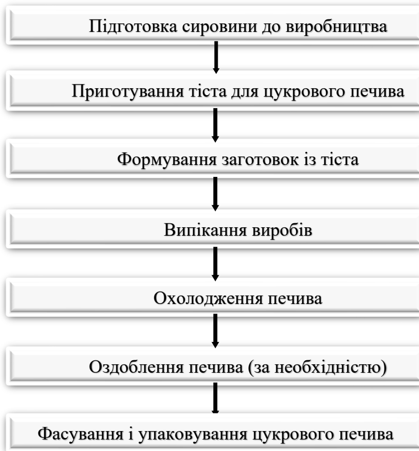
Рисунок 2.1 - Технологічна схема виробництва цукрового печива «Новинка»
