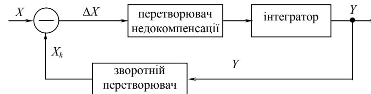
Рисунок 2.5 - Структурна схема вимірювального кола засобу вимірювання астатичне зрівноважування
