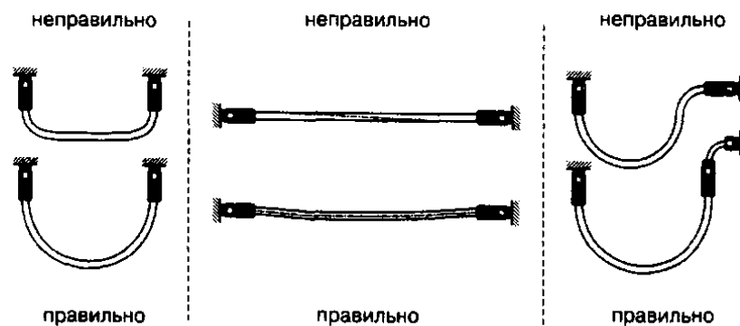
Рис. 1.3. Рекомендації щодо монтажу гнучких трубопроводів
