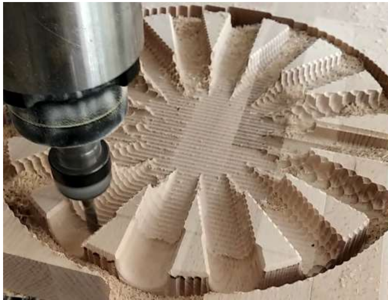
Рисунок 3.10 – Процес обробки траєкторного колеса на фрезерному верстаті з ЧПК.
