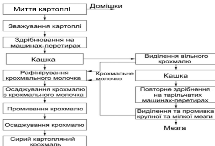
Рисунок 2 - Принципово-технологічна схема виробництва картопляного крохмалю
