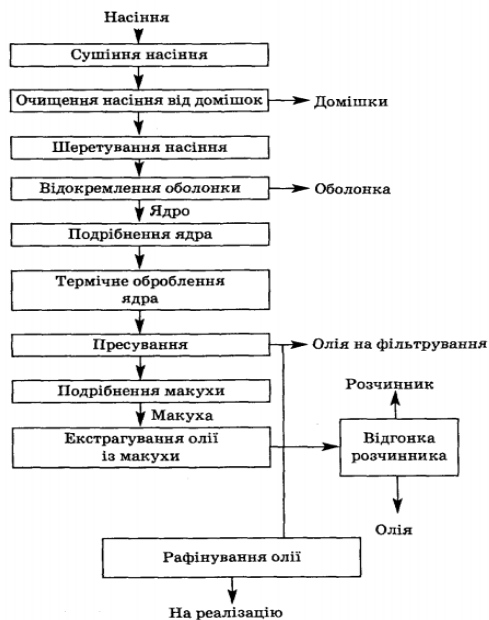
Рисунок 1 - Принципово-технологічна схема перероблення олійної сировини
