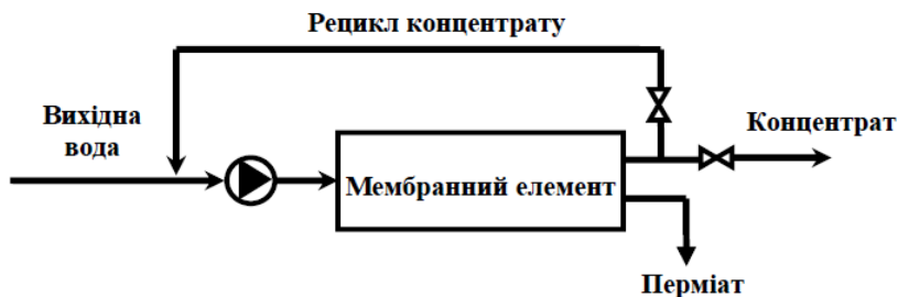
Рисунок 11 – Принципова схема системи зворотного осмосу і нанофільтрації з рециклом концентрату
