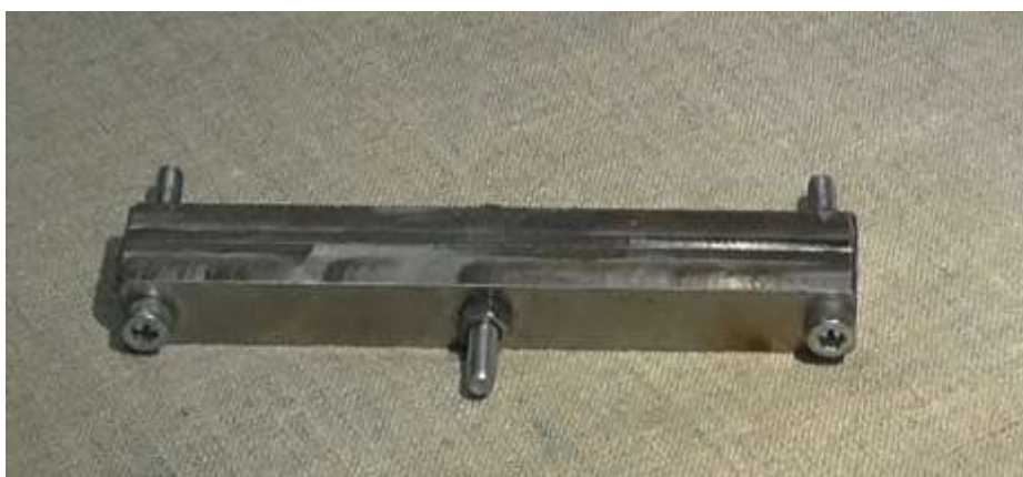
Рисунок 2.3 – Виливниця з сірого чавуну
