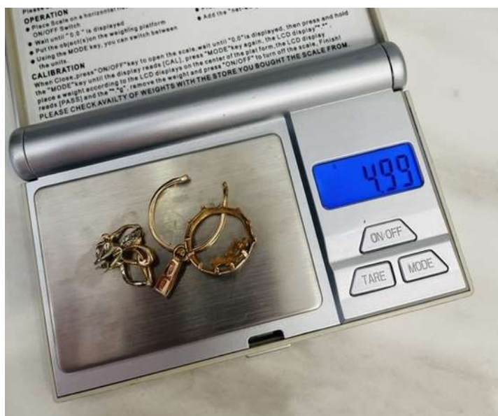
Рисунок 2.2 – Зважування залишків та відходів золотих виробів
