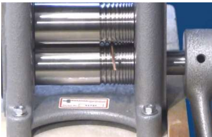
Рисунок 2.8 – Деформування зразків на ювелірних вальцях
