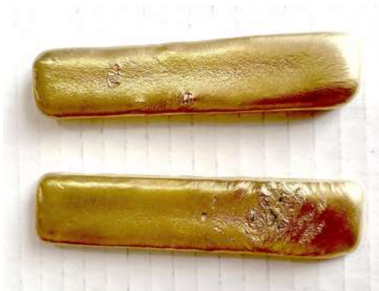
Рисунок 2.4 – Зразки золота після відливання
