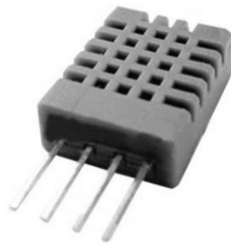
Рисунок 1.4 – Цифровий сенсор температури і вологості DHT11 [14]
