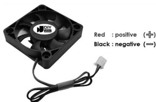
Рисунок 2.2 – Вентилятор охолодження DC fan [20]
