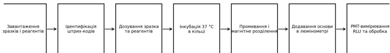
Рисунок 3.10 – Узагальнений функціональний технологічний процес в системі ADVIA Centaur CP
