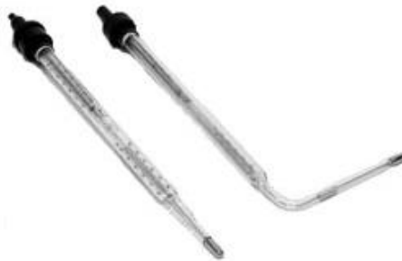
Рисунок 2.2 – Технічні скляні електроконтактні термометри: а – прямий; б – кутовий
