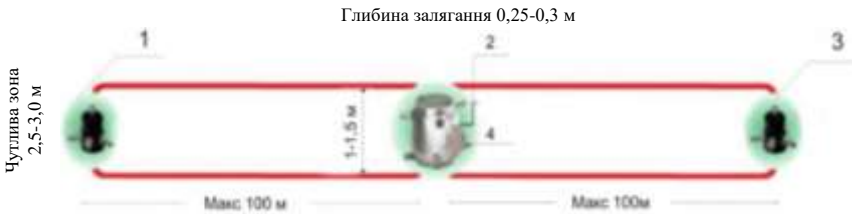
Рисунок 2.27 – Двохтрубна версія манометричного засобу виявлення: 1, 3 – компенсаційні клапани; 2 – кабель до блоку керування (підземний); 4 – сенсор
