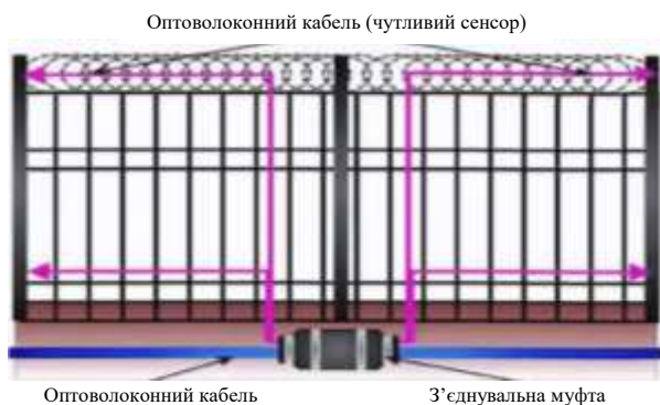
Рисунок 2.45 – Приклад монтажу оптоволоконної системи виявлення
