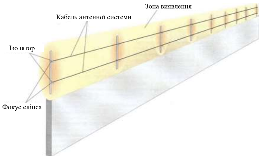
Рисунок 2.1 – Зона виявлення ємнісного сповіщувача
