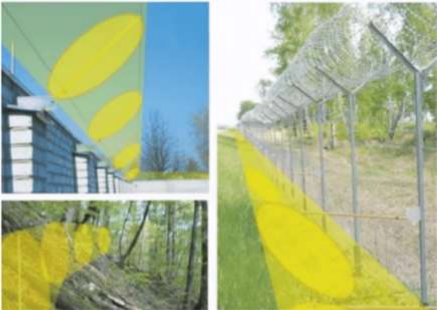
Рисунок 2.9 – Зони виявлення провідниково-хвильового сповіщувача
