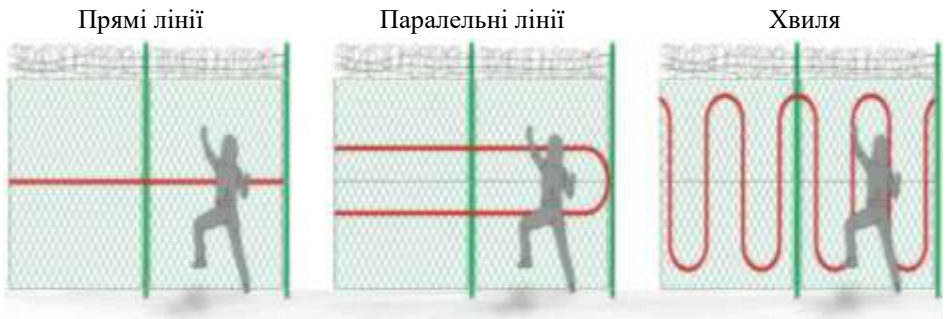
Рисунок 2.34 – Приклад монтажу вібраційного сповіщувача на огорожі
