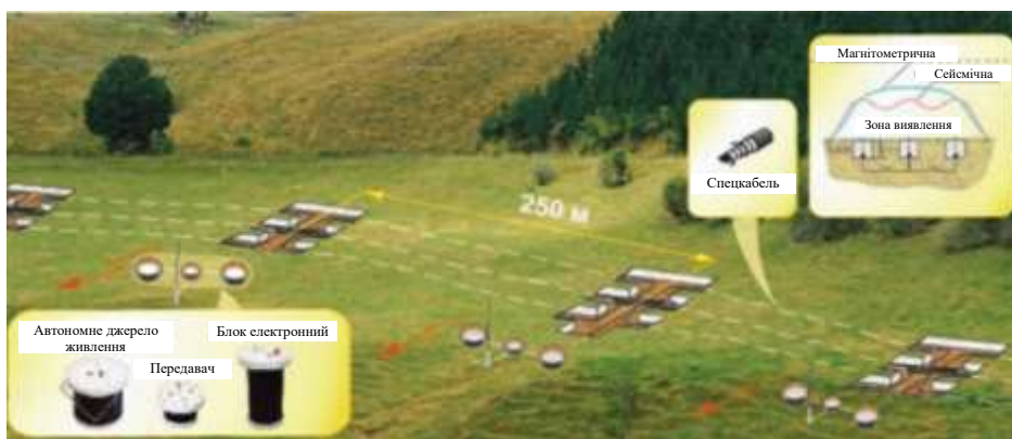
Рисунок 2.20 – Сейсмомагнітометричний радіоканальний засіб виявлення
