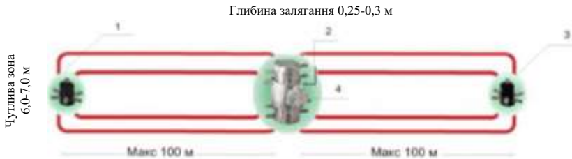
Рисунок 2.28 – Чотирьохтрубна версія манометричного засобу виявлення: 1, 3 – компенсаційні клапани; 2 – кабель до блоку керування (підземний); 4 – подвійний сенсор
