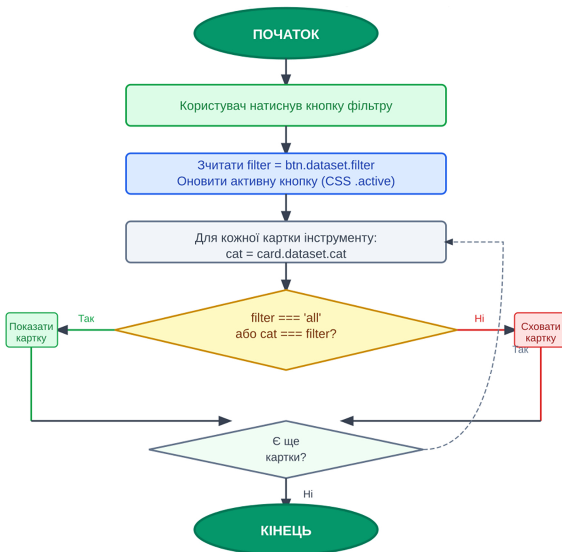
Рисунок 2.6 – Блок-схема алгоритму фільтрації каталогу інструментів
