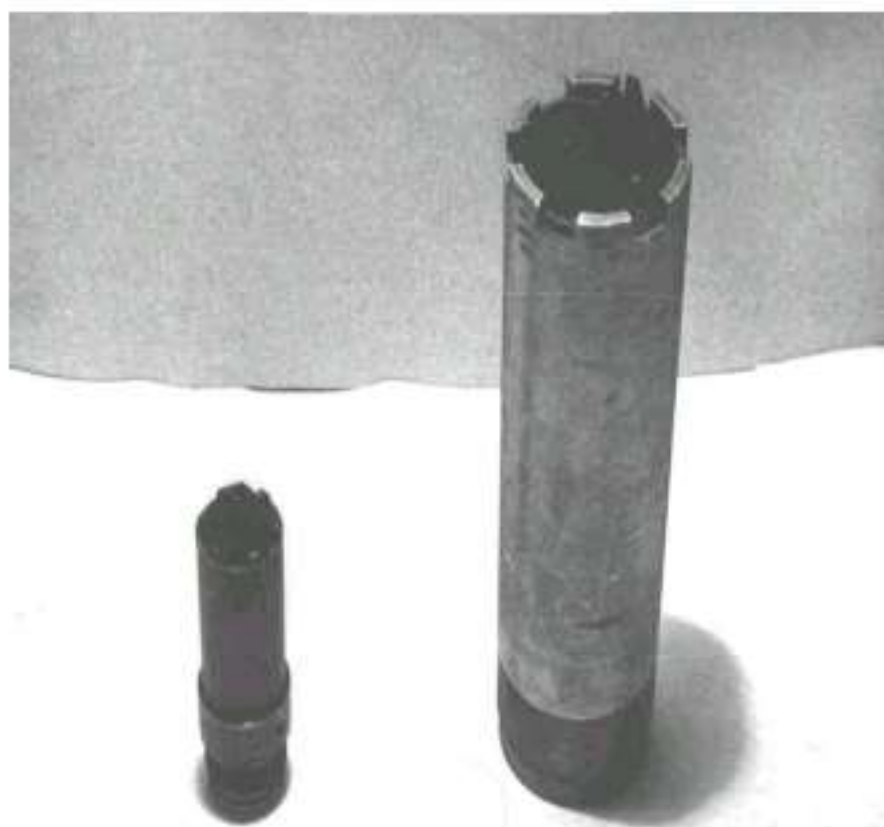
Рисунок 3.3 Подаючі цанги з відігнутими пружними затискними елементами
