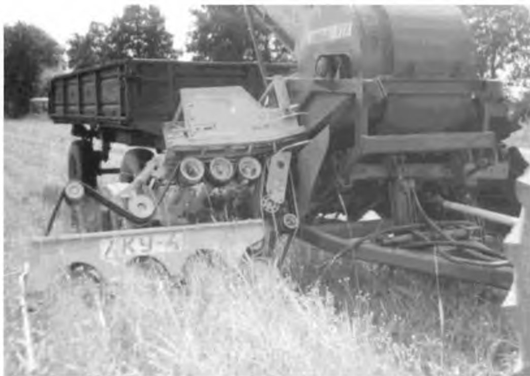
Рисунок Б.4 - Універсальна льонозбиральна машина ЛКУ-4 в роботі як комбайн
