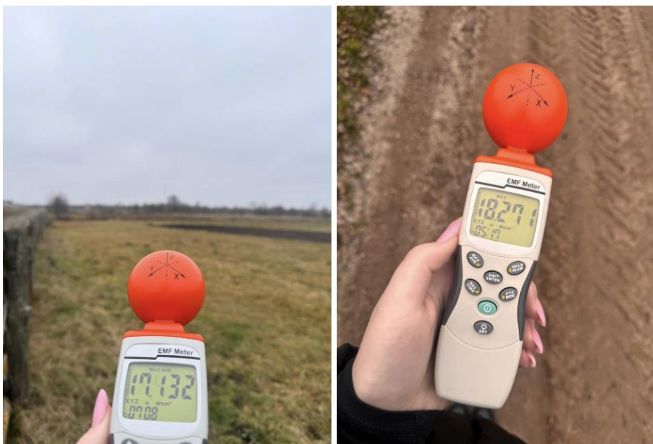
Рисунок 3.6 Фіксація одиничних пікових значень рівнів електромагнітного випромінювання на різних відстанях від базової станції
