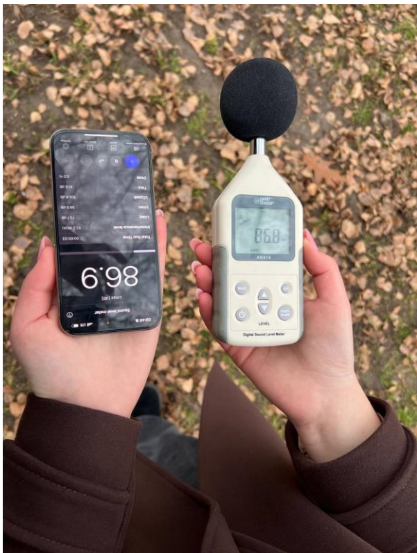
Рисунок 3.7 Зображення мобільного додатку NIOSH Sound Level Meter (ліворуч) та шумоміра GM1358 (праворуч)
