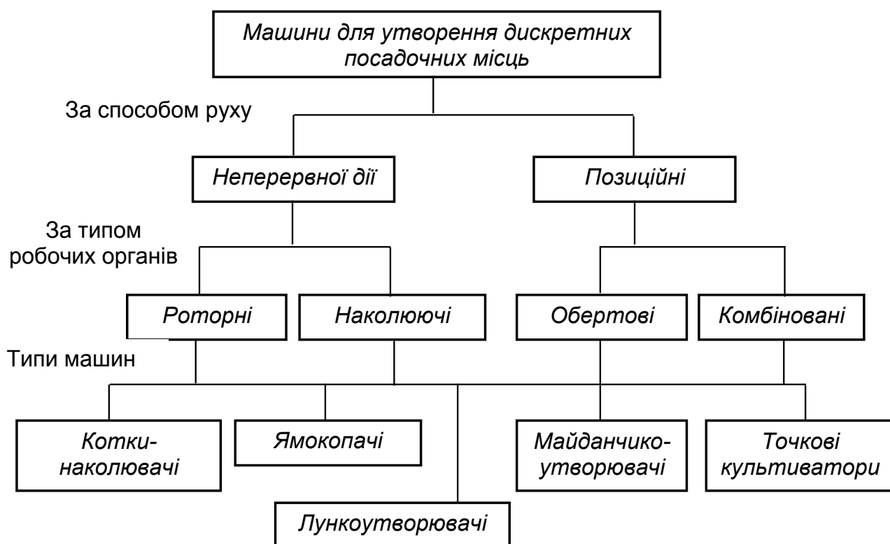
Рисунок 1.1 Класифікація машин для утворення дискретних посадочних місць [3]
