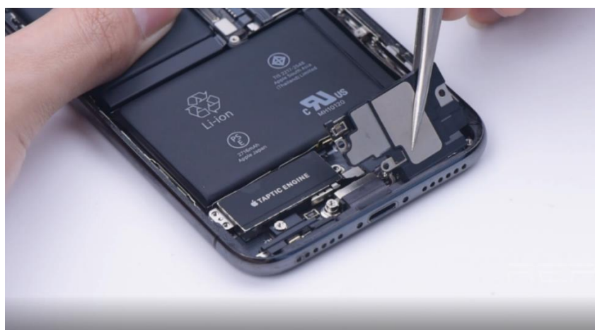
Рисунок 3.18 – Процес зняття захисних пластин, модуль Taptic Engine і гучномовця [22]
