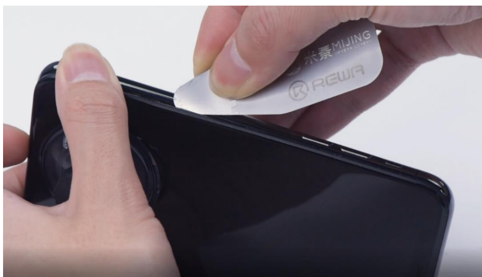
Рисунок 3.15 – Процес відкриття телефону за допомогою присоски та пластикової лопатки [17]
