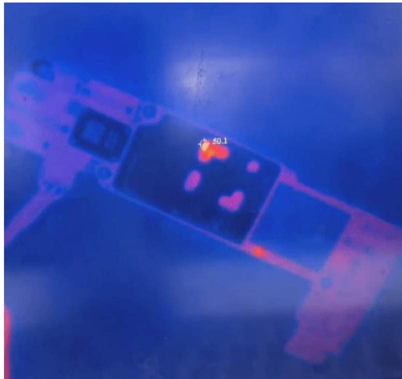
Рисунок 2.11 – Тепловізійне зображення контролера U2 [14]
