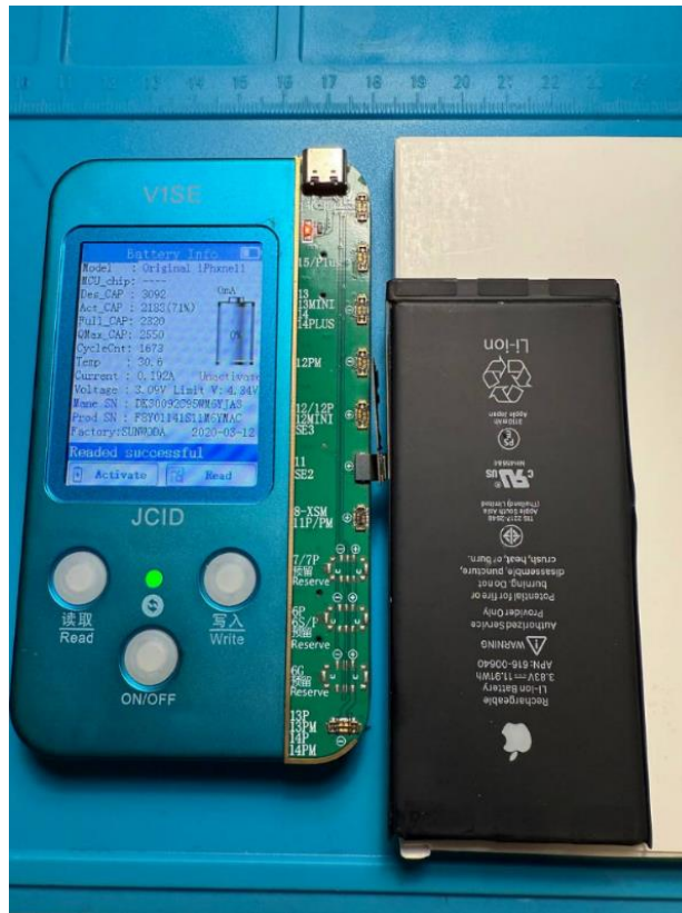
Рисунок 3.26 – Програматор JCID підключений до акумулятора
