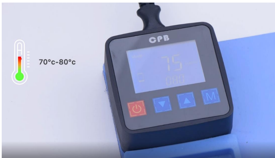
Рисунок 3.14 – Процес нагрівання платформи для подальшого ремонту [21]
