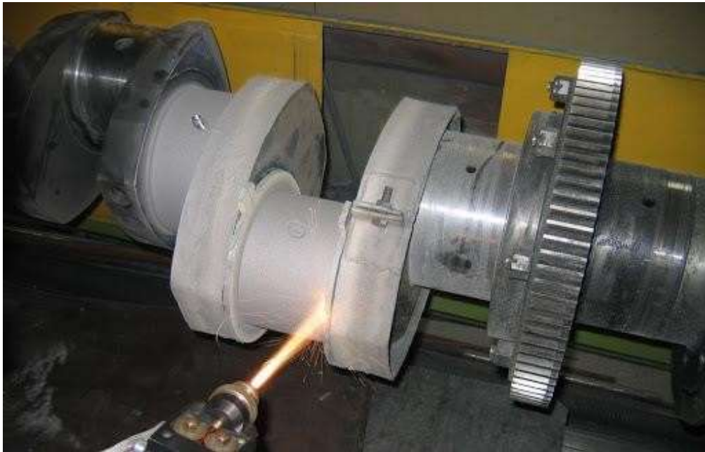
Рисунок 2.4 – Плазмове нанесення покриття при відновленні валу
