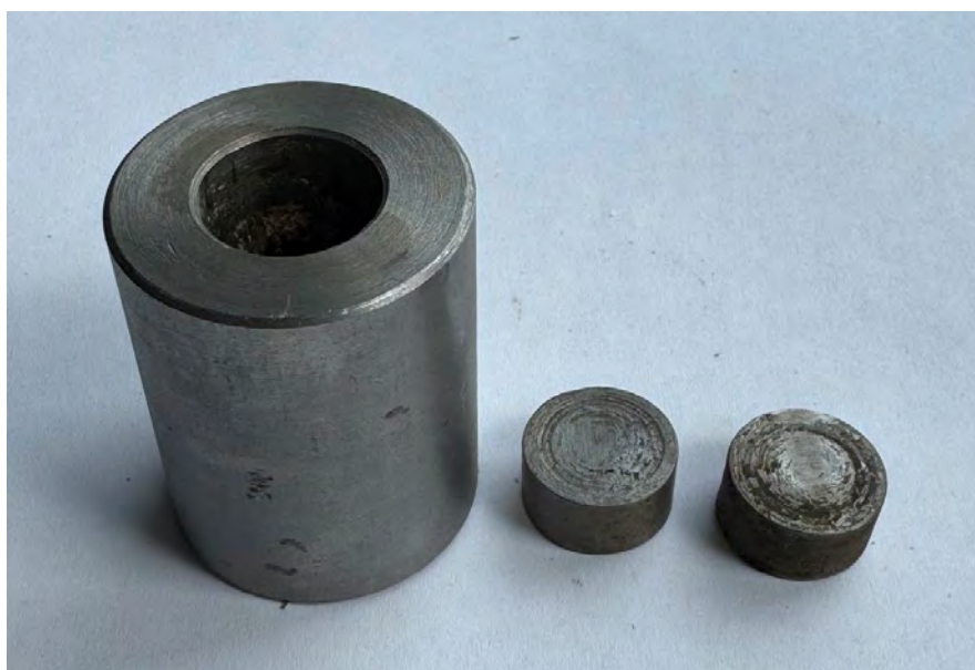
Рисунок 2.3 – Матриця та пуансони прес-форми
