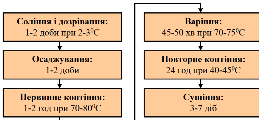
Рисунок 1.2 – Технологічний цикл виготовлення варено-копчених ковбас
