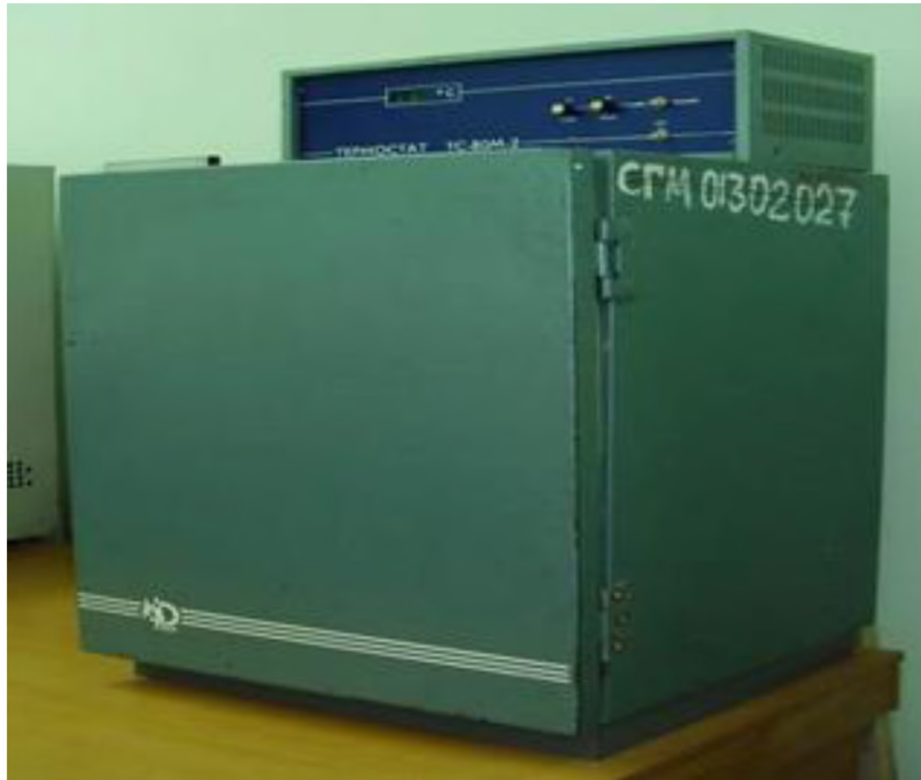
Загальний вигляд сушильної електрошафи СНОЛ 3.5
