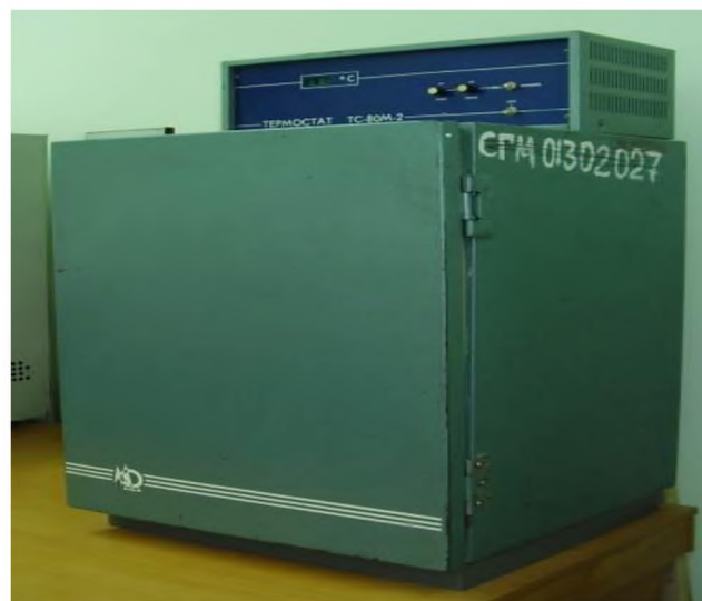
Рисунок 3.1- Загальний вигляд сушильної електрошафи СНОЛ 3.5
