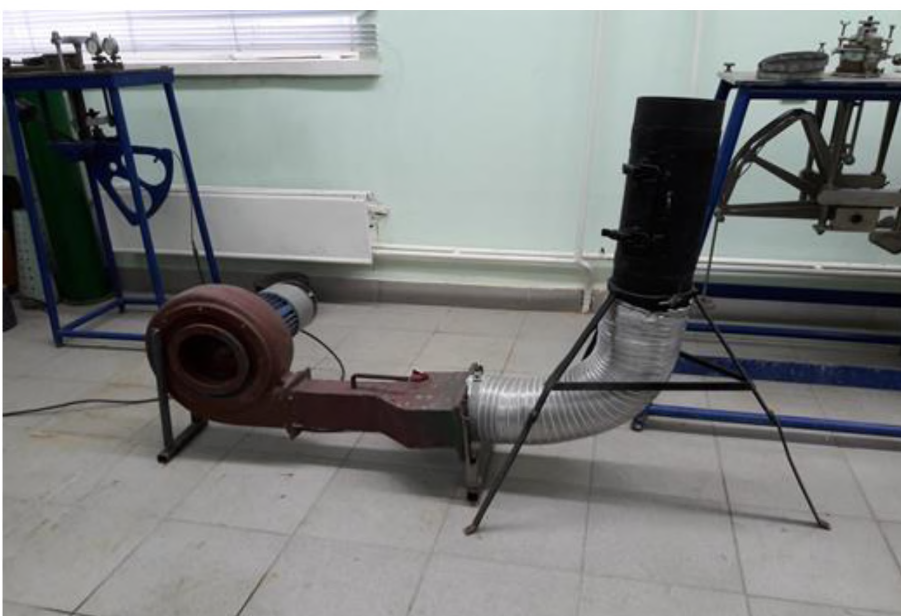
Лабораторна установка для дослідження процесу сушіння насіння ріпаку
