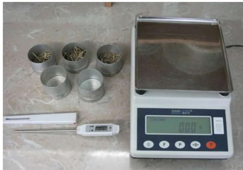
Рисунок 3.2 – Загальний вигляд електронної ваги ТВЛ-0.5 та термометра-щупа
