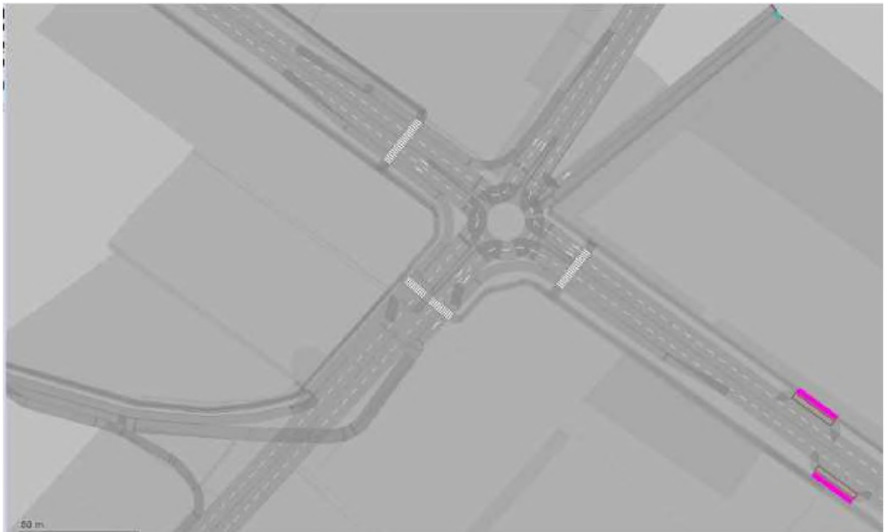
Рис. 2.1. Модель кільцевої розв'язки на перехресті вулиць Дубнівська – Карпенка-Карого, виконана у PTV Vissim
