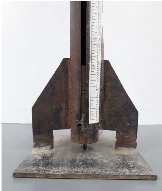
Рисунок 2.2 – Прилад типу У1 для досліджень на динамічну стійкість
