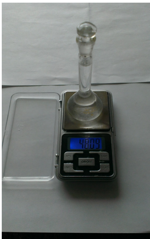
Рис. 4.27. Зважування пікнометра з рідиною та зразком
