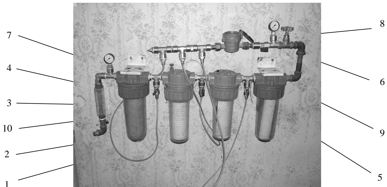
Рис. 5.1. Загальний вигляд установки для визначення проникливості ППМ: 1 – корпус; 2 – досліджуваний зразок; 3 – ущільнювач; 4 – кришка; 5 – координатний пристрій; 6 – джерело тиску; 7, 8 – манометри; 9, 10 – датчики.
