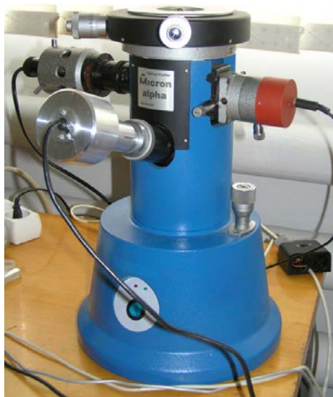
Рис. 1.8. Безконтактний інтерференційний тривимірний профілометр «Мікрон-альфа»
