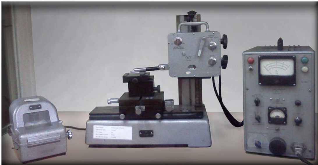
Рис. 1.4. Профілограф-профілометр для визначення шорсткості та хвилястості поверхонь
