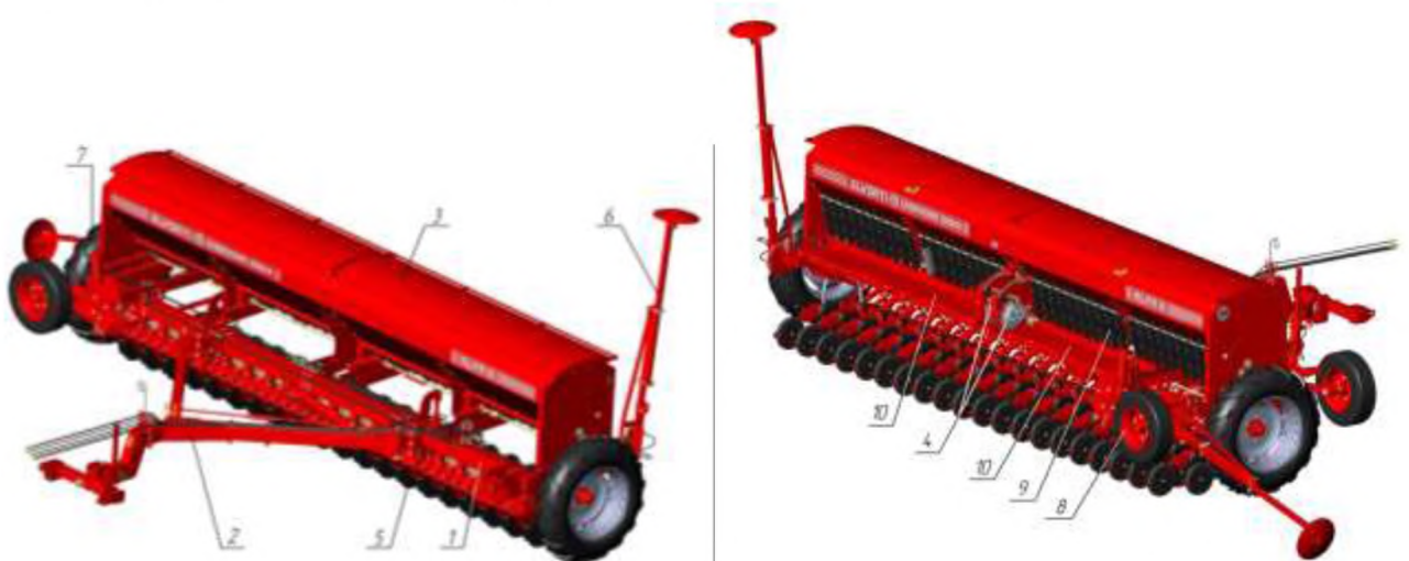
Рисунок 1.5 Сівалка ALFA 6: 1 – рама; 2 – причіпний пристрій; 3 – бункер; 4 – варіатори; 5 – сошник; 6 – маркер; 7 – опорно-приводне колесо; 8 – колесо для транспортування; 9 – висівний апарат; 10 – підніжна дошка; 11 – загортач [8]
