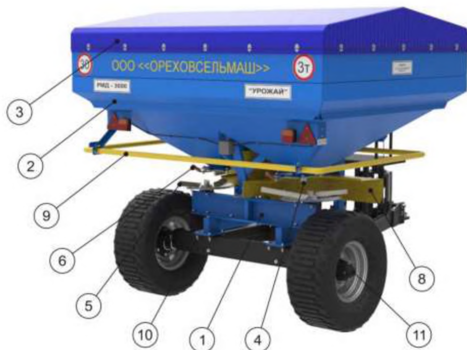
Рисунок 1.7 Розкидач мінеральних добрив РМД-3000 [10]: 1 – рама, 2 – бункер; 3 – тент; 4 – дозуючі пристрої; 5 – розподільчі диски; 6 – важелі для регулювання норми внесення добрив, 7 – редуктори; 8 – захисні щітки, 9 – труба огороження; 10 – візок, 11- піввісь;
