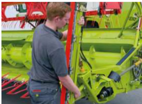
Рисунок 1.9. Встановлення ріпакового ножа за допомогою швидкознімних замків [11]
