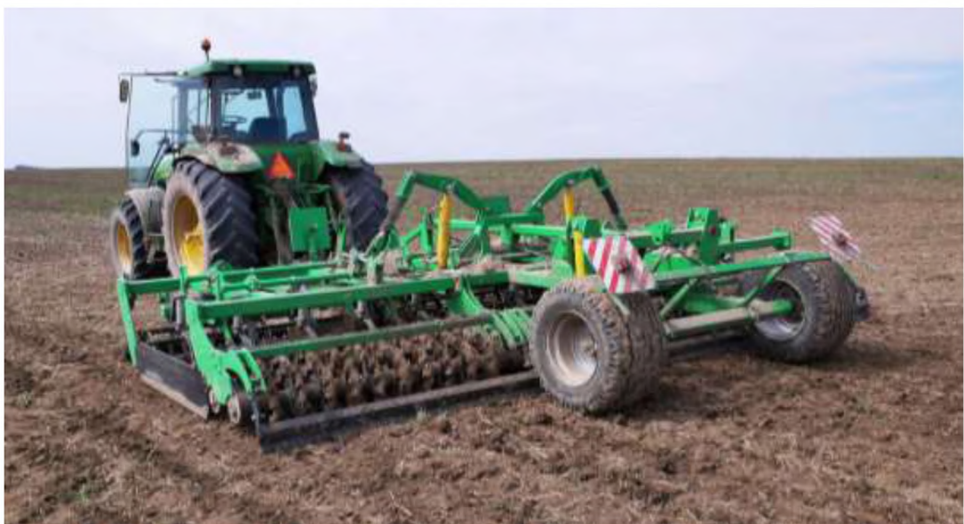
Рисунок 1.6 Фото знаряддя FORWARD 6 для комбінованого обробітку ґрунту під ріпак [7]
