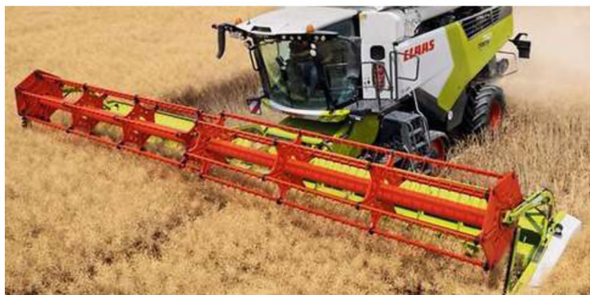
Рисунок 1.10. Фото реалізації концепції роздільного мотовила у жатці VARIO 1380 [11]
