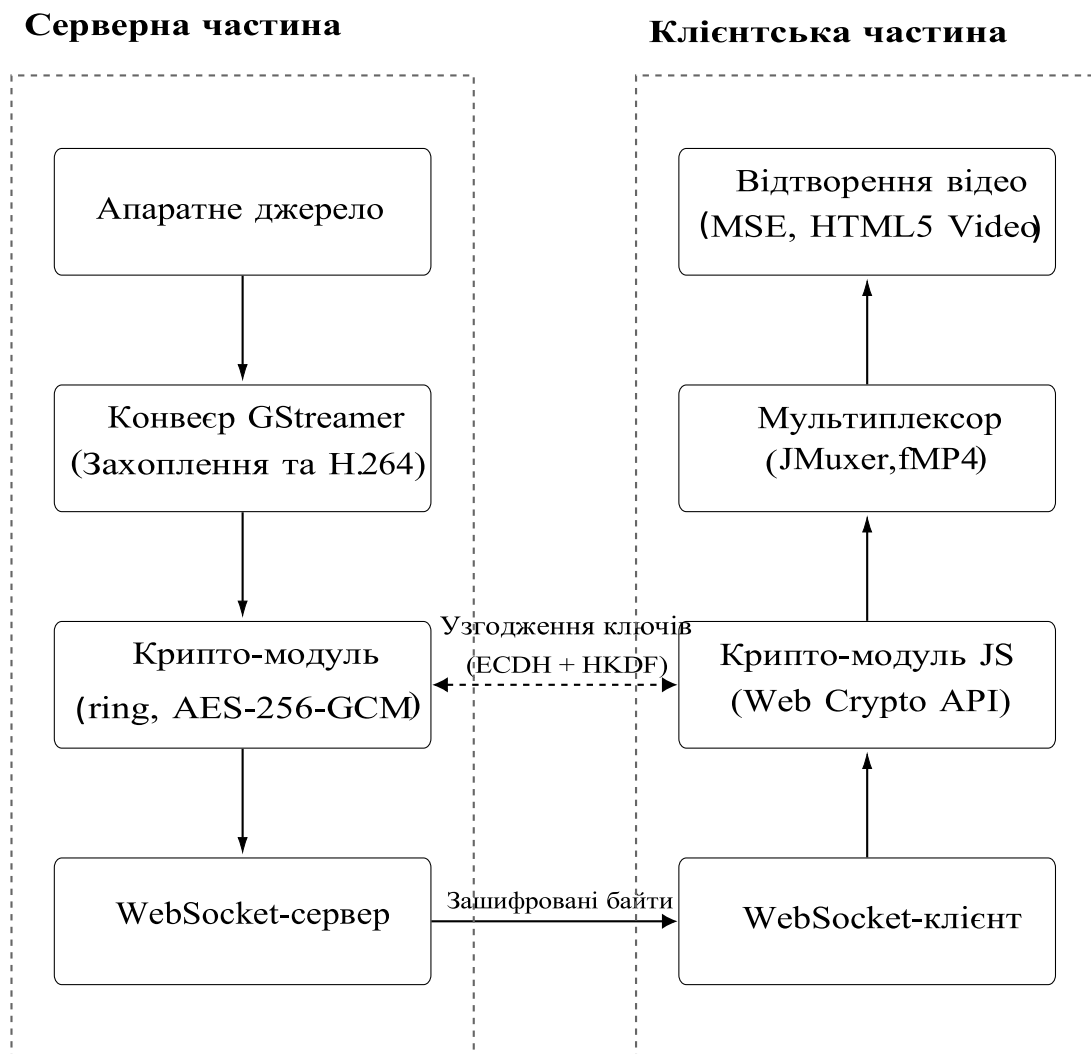
Рисунок 3.1 – Архітектурна схема взаємодії компонентів
